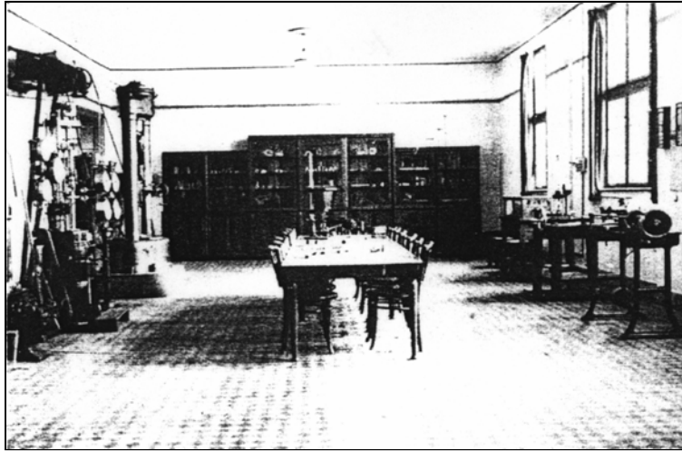
Fig. 3. – La salle d'essais mécaniques du Laboratoire de l'Ecole Polytechnique de Timișoara. On peut voir: la machine Mohr et Federhaff de 50 tf; la machine Losenhausen de 10 tf; la machine Rejtő de 800 kgf pour des tissus; l'appareil de dureté Martens; la machine de torsion Amsler.
